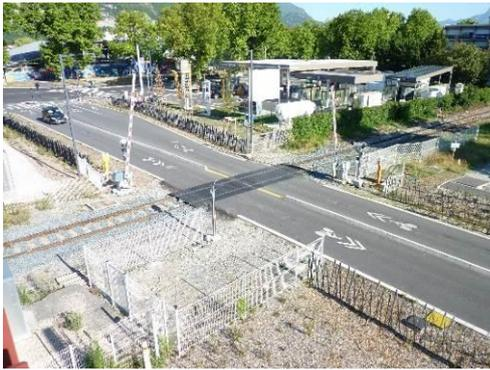
Ainsi, le PN6, situé juste au nord de la future halte, a été sécurisé par la mise en place d'une passerelle piétonne. Présentant auparavant des difficultés et des risques, il est à présent composé de barrières et de feux de signalisation coordonnés avec le carrefour à feux du Cours Saint-André.
