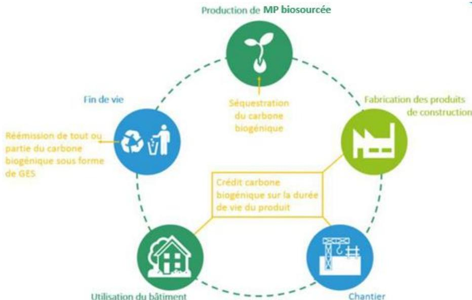
Figure 3 : Cycle de vie d'un produit biosourcé (source : Build Green)
